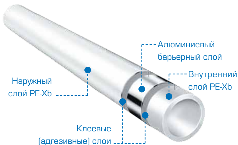
Рис. 4. Пятислойная металлополимерная труба PE-Xb/Al/PE-Xb
