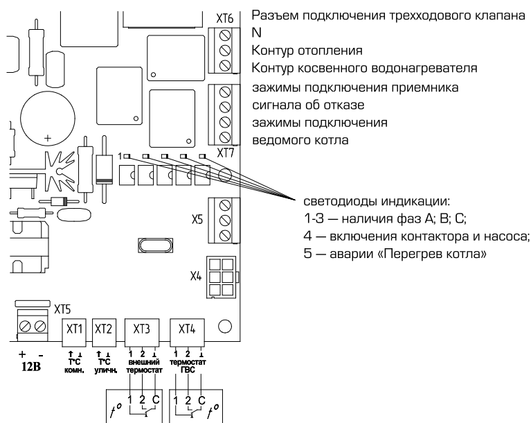
Рис. 5. Расположение разъемов на плате контроллера
