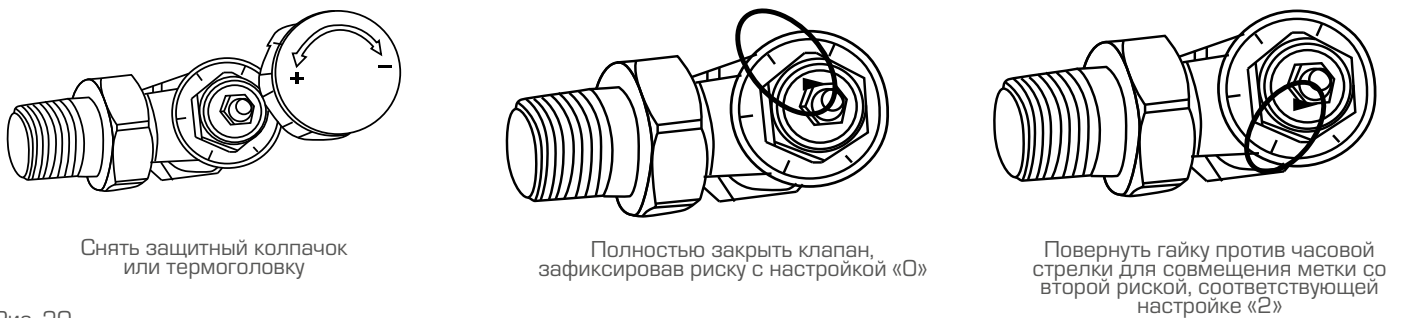
Рис. 20. Пример преднастройки клапана терморегулятора
