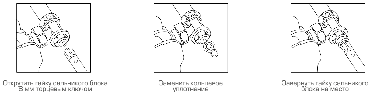
Рис. 21. Замена кольцевого уплотнения штока клапана терморегулятора
