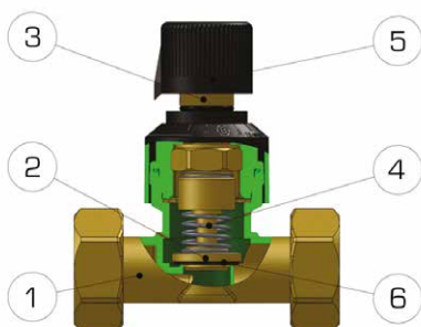
Рис. 11. Устройство перепускного байпасного клапана
