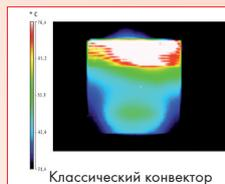
Распространение тепла от нагревательной HD панели в сравнении с классическим конвектором
